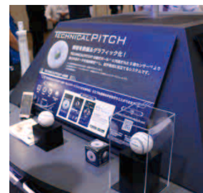
センサと無線通信デバイスが埋め込まれた「ボールセンサ」
