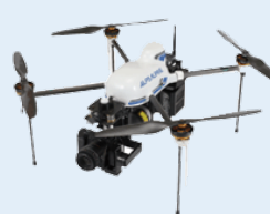
架空地線自動追尾点検 ドローンシステム
