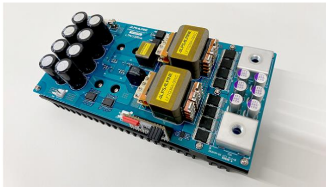
Bild 4. Prototyp eines isolierten TriMagiC Converters (Gleichspannungswandler) zur Evaluierung der Funktionalität
