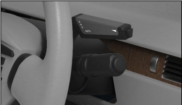
▲车载电动驻车制动器示意图
